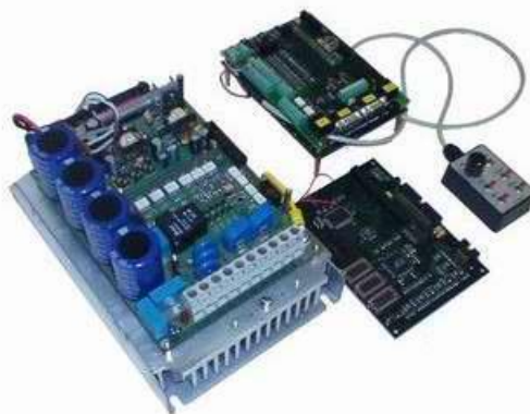
4.23 Сурет – Басқару панелі бар конвертер тақтасы
